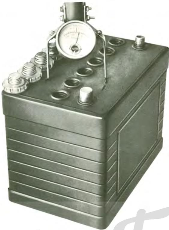
Der Säurestand soll sich ca. 10 mm oberhalb der Platten befinden. Dann nacheinander mit einem Batterie-Prüfgerät jede Zelle auf Spannung prüfen
