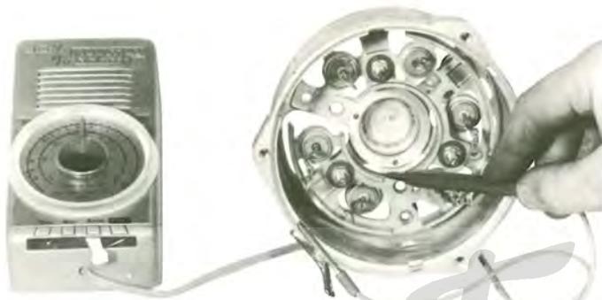
**KONTROLLE DER ISOLIERUNG DES POSITIVEN DIODEN-TRÄGERS**
