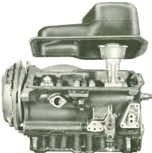
Den Motor sorgfältig reinigen und an einer zweckmäßigen Stützvorrichtung, ähnlich der Desvil-Vorrichtung, anbringen.
