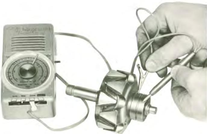
Anschliessend die Krokodilklemme auf dem zweiten Kollektoring ansetzen
