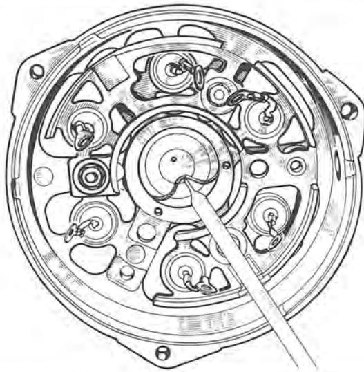
**AUSTAUSCH DES DICHRINGES DES HINTEREN GEHÄUSES**
