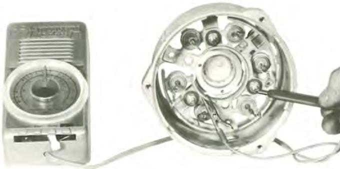
**KONTROLLE DER ISOLIERUNG DER VERBINDUNGSKLEMMEN**
