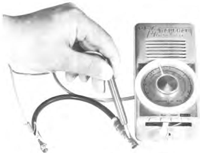
Ein zusätzlicher Widerstand von ca. 6800  $\Omega$  wird an jeden Zylinder zwischen Kontaktfeder und Zündkerze gebracht
