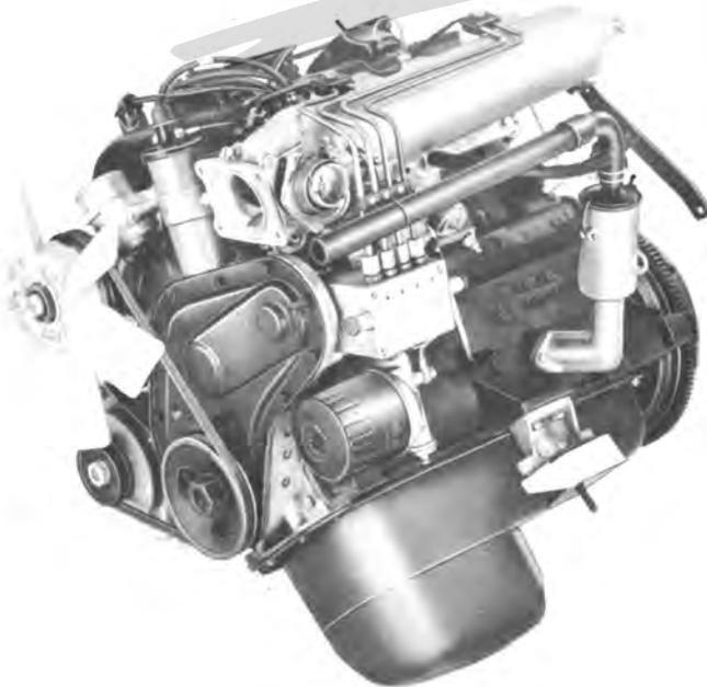
MOTOR 504 MIT BENZIN-EINSPRITZANLAGE
